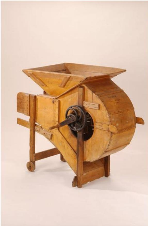
**Le tarare :** avec le tarare sont effectuées deux opérations, le nettoyage des grains et le triage. On met les grains dans la trémie du dessus. On tourne la manivelle qui actionne une sorte de ventilateur qui fait voler les déchets. Quand les grains tombent dans l'entonnoir, ils tombent sur des cribles (grillages) superposés, décalés les uns par rapport aux autres et légèrement secoués pour trier les grains. Le tarare est apparu en brie vers 1771. Le tarare fut remplacé
